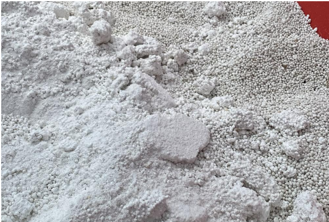
Figuur 1 Vochtschade in kunstmestsilo. Te zien aan plakken kunstmestkorrels met aan de ene kant vastgeplakt poeder en andere kant kunstmest korrels
